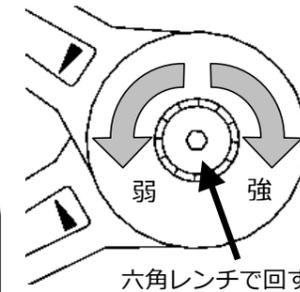
フラップステーの中央の調整部を、4mmの六角レンチで回してブレーキの強さを調整してください。左右のブレーキの強さは同じにしてください。開閉不良・ブレーキの早期磨耗・脱落の恐れがあります。
