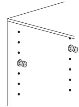
3 カムロックを プラスドライバーで締め込みます。
