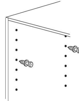
2 固定棚板を上からジョイントピンに差し込みます。
