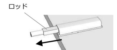
扉を閉めるときは、プッシュオープンのロッドを完全に飛び出させてから、扉を閉めてください。完全に飛び出していない状態からは、ロッドが戻れなくなり扉が閉められません。
