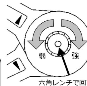
フラップステーの中央の調整部を、4mmの六角レンチで回してブレーキの強さを調整してください。左右のブレーキの強さは同じにしてください。開閉不良・ブレーキの早期磨耗・脱落の恐れがあります。
