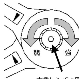
フラップステーの中央の調整部を、4mmの六角レンチで回してブレーキの強さを調整してください。
