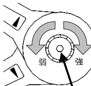
フラップステーの中央の調整部を、4mmの六角レンチで回してブレーキの強さを調整してください。
